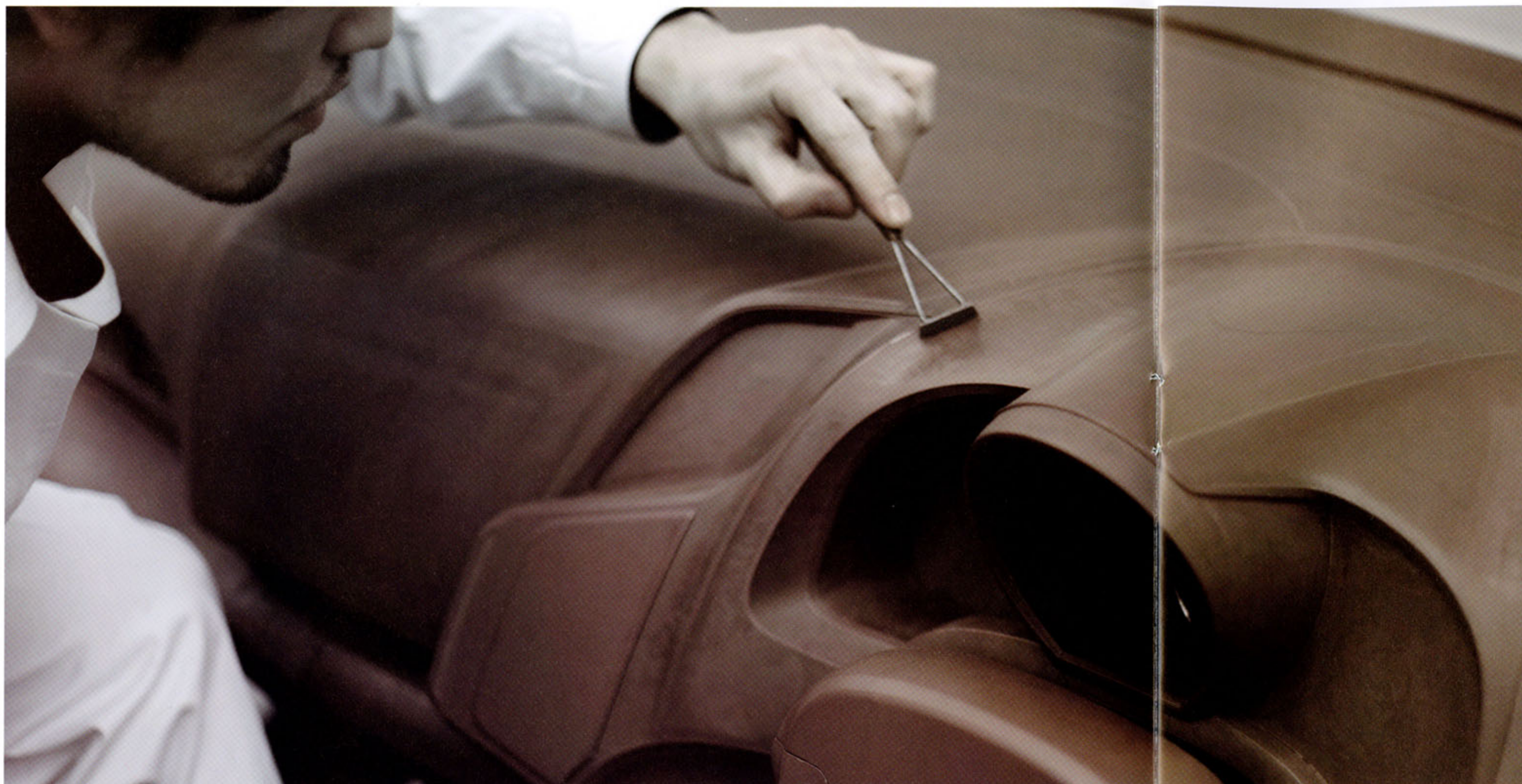
インストルメントパネルのクレイモデル制作。スイッチ類の位置など、細部まで機能性を徹底追求。そのうえで先進的な造形をつくり込んだ。
