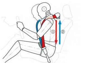
①強い衝撃を感知すると、瞬時に巻き取る。 ②一定以上の荷重がかかると、送り出す。 作動イメージ図
