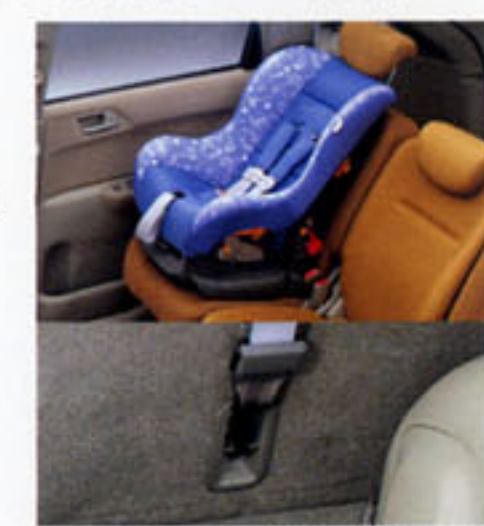
テザーアンカー部
