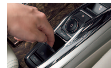
指先でスイッチを引き上げれば作動する「電子制御パーキングブレーキ」。発進時は戻す手間なく、アクセルONで自動解除。
