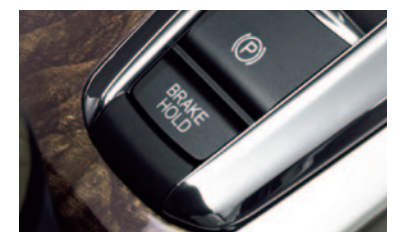
停止時、ブレーキペダルを放してもブレーキを保持し続ける「オートブレーキホールド機能」。アクセルONで自動的に解除。
