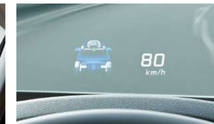
ステアリングスイッチの切り替えで、様々な情報をフロントウインドウに映せるヘッドアップディスプレイ。
