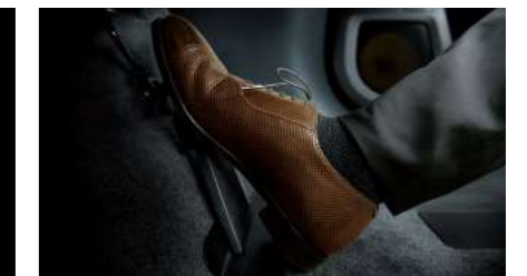
踏み応えの重さの変化や振動で様々な情報をドライバーに伝えるリアクティブフォースペダル。
