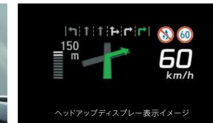
ヘッドアップディスプレイは、交差点で進路を示すTurn by Turn表示、標識認識機能の表示も可能。
