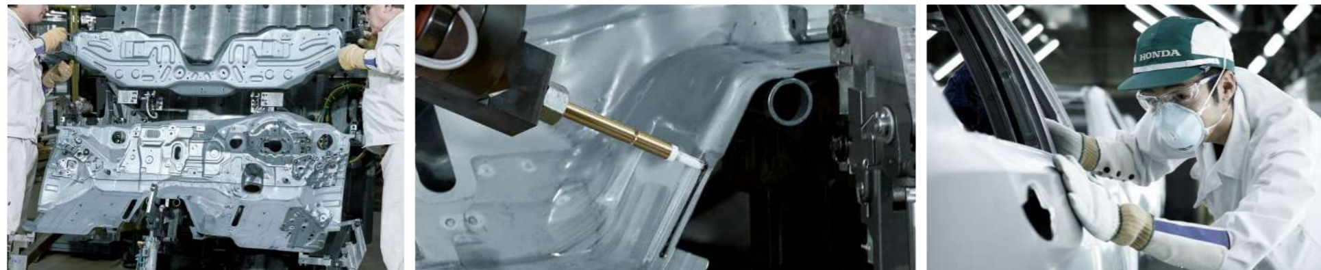
骨格の剛性感を高めるべく、レジェンドが生産される埼玉製作所に、意図した部位に正確に接着剤を塗布する専用設備を導入した特別な工程を追加。人の技も注ぎ込み、進化した骨格が作り上げられます。
