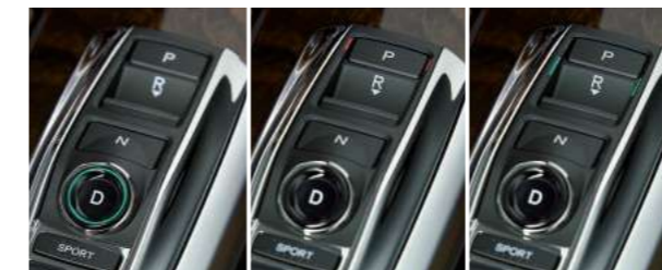
スイッチの判別性を高める、緑と赤のランプも採用したエレクトリックギアセレクター。
